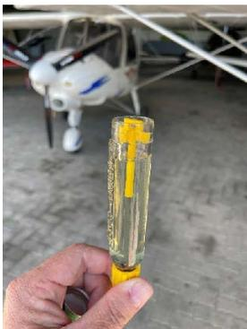
Bild 2 zeigt, wie das Benzin aussah, das nach dreimaligem Drainen aus dem Tank abgelassen wurde.
