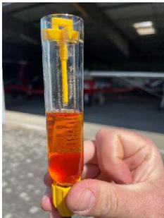
Im Bild 1 ist zu erkennen, wie das Super Plus Benzin in einem UL aussah, als dieses nach ca. fünf Monaten Standzeit angefliegen kam und durch mich dann gedrainet wurde.
