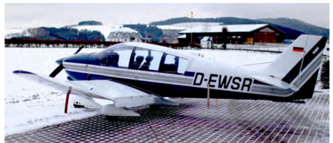
Nicht nur im Winter: Staurohr und Öffnung für den statischen Druck sichtbar verschlossen.
