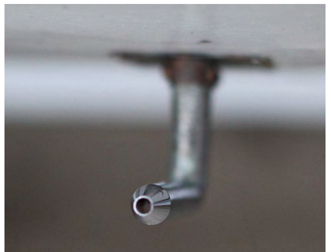
Was soll da am Boden schon da reinkommen? Pitot-Rohr einer Robin DR400R/180
