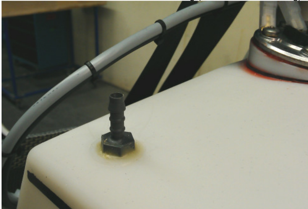
Bild 6 Einschraubstutzen für Rücklaufleitung (Tank mit Vorbereitung)
