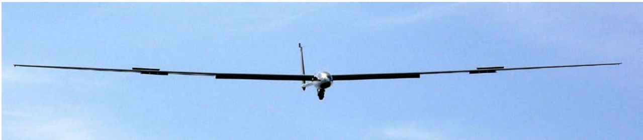
Mit den 1,5 m 2 großen Landeklappen sind sehr steile Anflüge und kurze Landungen möglich.
