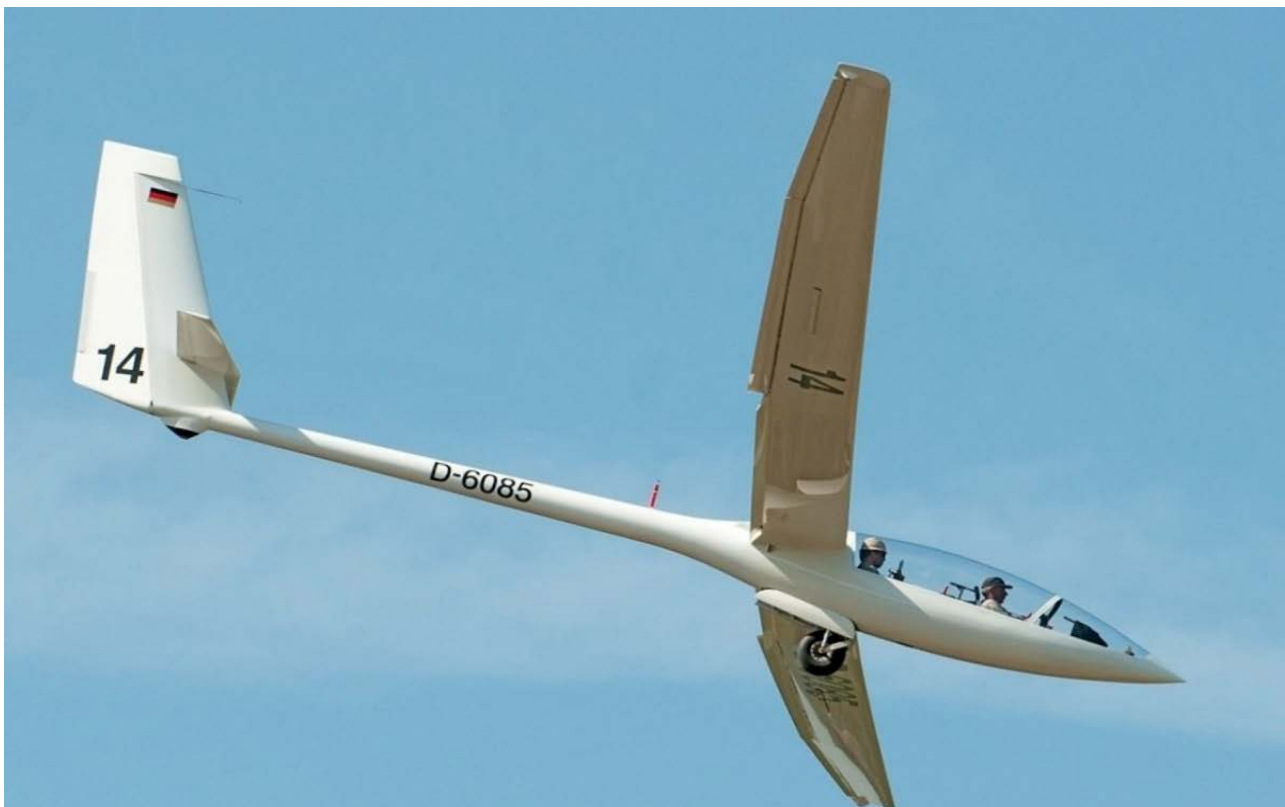
Mit den 1,5 m 2 großen Landeklappen sind sehr steile Anflüge und kurze Landungen möglich.
