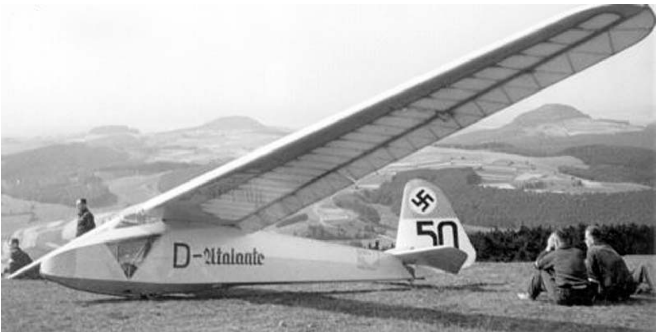
Mü13 Atalante Die Bereiche des Querruders und der Wölbklappe sind gut zu erkennen
