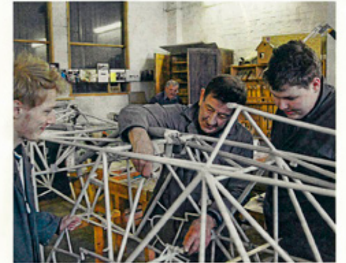
Bernd Junker (Mitte) restauriert mit den Schülern Julian (links) und Wiso (rechts) den 60 Jahre alten Segelflugzeug „Bergfalken“.
