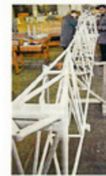
Das lange Stahlgerippe muss noch bespannt werden. Als Nächstes wird die Steuerung eingebaut.
