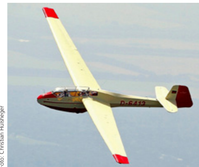
Der Bergfalken II/55 ist ein in Gemischtbauweise hergestellter, freitragender Mitteldecker der 1950er Jahre.
