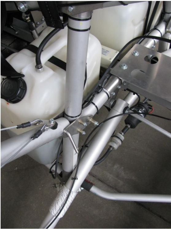
Stielaufnahme mit Edelstahlplatten (4mm)
