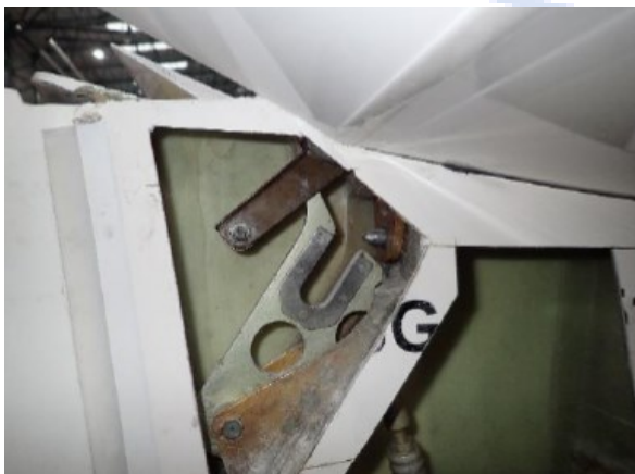
falsch montierte Höhenruderansteuerung
